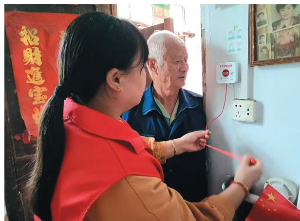
能。借鉴外地经验，结合本地平房密集的特点，为独居老人安装了一键呼叫设备。设备采用大按键加拉绳的简易设计，固定在床头等易触及位置。老人一旦遇到困难按下呼叫键，系统便会呼叫预设的网格员、子女、邻居等5个联系人，确保求助信号第一时间被多方接收，实现了“平安有人守、求助有人应”。
