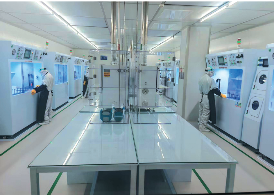
安芯电子清洗室里,工人正在使用全自动化的清洗设备去除晶圆表面杂质
