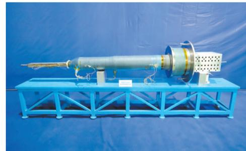
7月17日,记者从中国科学院合肥物质科学研究院获悉,该院等离子体物理研究所自主研发的一对CRAFT 100kA(千安培)高温超导电流引线顺利通过极端工况下的性能测试,其稳态载流能力突破100kA,创造世界纪录,为大型聚变装置超导磁体系统的建设和运行奠定了坚实的技术基础。
