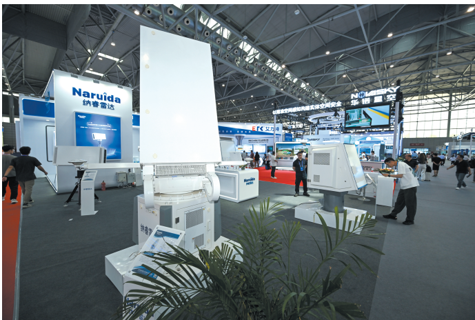
用于水利和科研的有源相控阵测雨雷达
