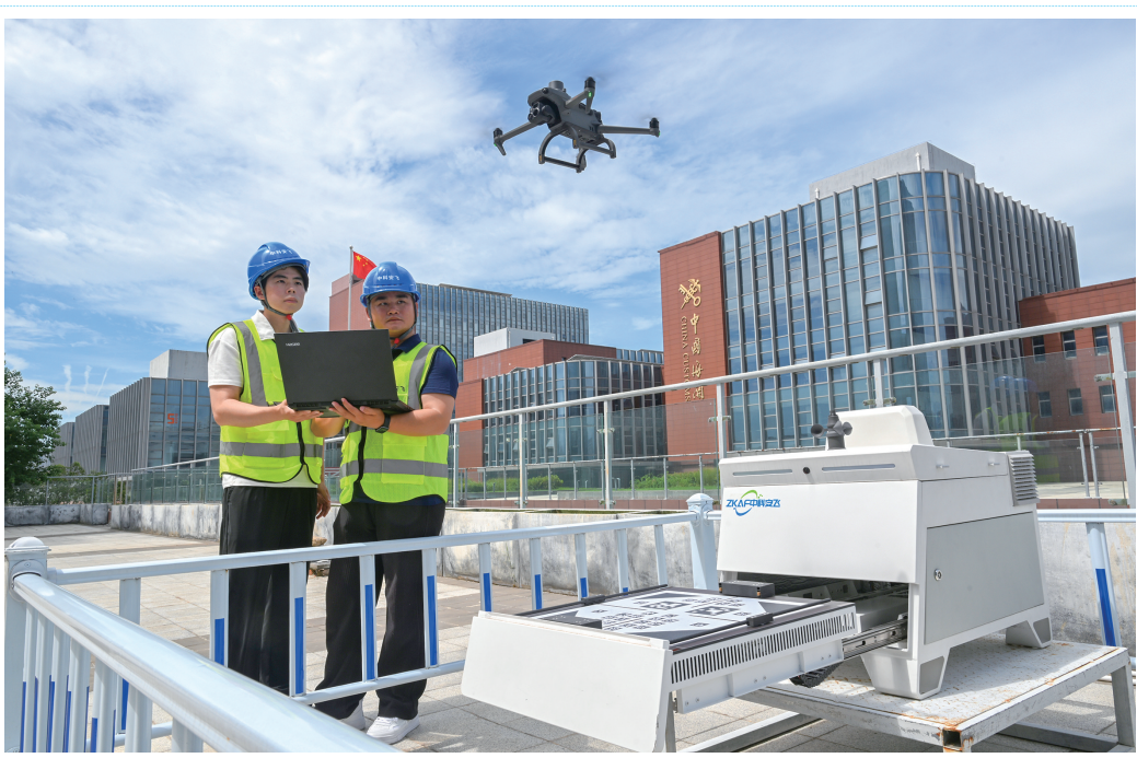
8月2日,在位于合肥蜀山经开区的中科安飞(合肥)科技有限公司,技术人员在对无人机自动机库进行测试。该企业致力于通过在城市内网格化部署无人机智能机库,实现低空领域对城市全方位监测,为相关职能部门提供丰富的数据和高效的管理手段。 星级记者 黄洋洋/图
