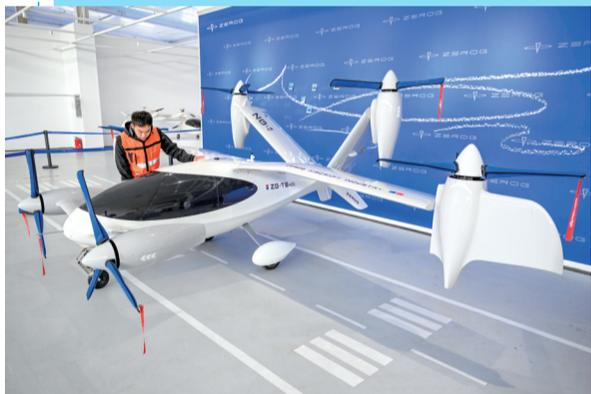
零重力ZG-T6倾转旋翼eVTOL飞行器(模型)。
