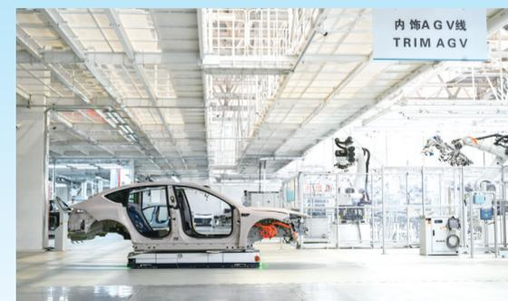
工厂在全球范围内首次采用“飞地”智能装配岛,拥有18台定制的高精度AGV,将前后风挡、玻璃车顶、仪表台和尾门四大件集成在同一个智能装配岛内完成安装
