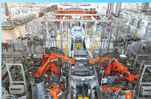
高精度四门智能装配,机器人全自动安装好全车四扇门只需98秒
