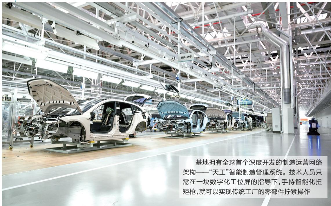
基地拥有全球首个深度开发的制造运营网络架构——“天工”智能制造管理系统。技术人员只需在一块数字化工位屏的指导下,手持智能化扭矩枪,就可以实现传统工厂的零部件拧紧操作
