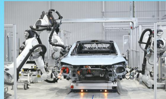
总装车间大量采用数字化技术,采用AGV自动装配工艺
