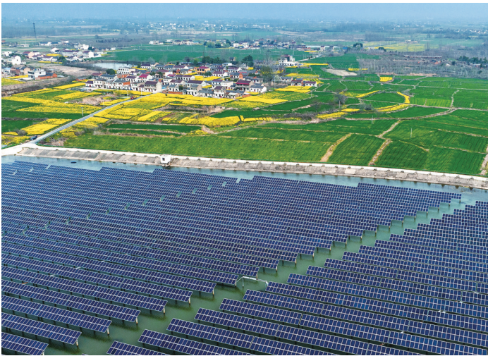
3月26日，肥东县梁园镇陷湖陂水库“渔光互补”光伏电站与周边的油菜花、麦田、村庄相映生辉。据了解，该光伏电站装机容量100兆瓦，综合利用水域面积2400亩，形成水上发电、水下养殖并行模式，年发电量达1.1亿度，提升当地电网运行水平，增加村集体经济收入。 王尚云/摄
