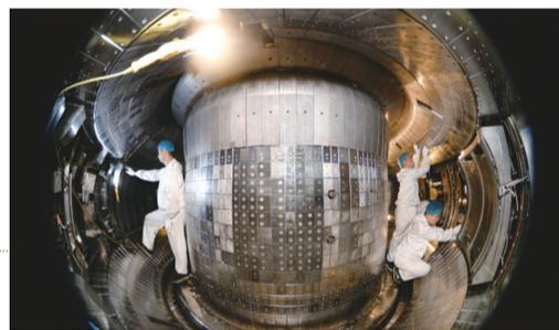
全超导托卡马克核聚变实验装置(EAST)真空室
