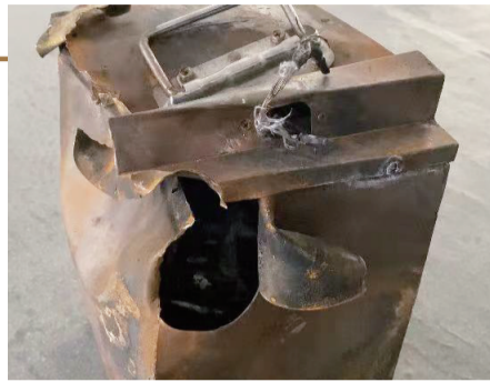
被烧毁的电动车电瓶
